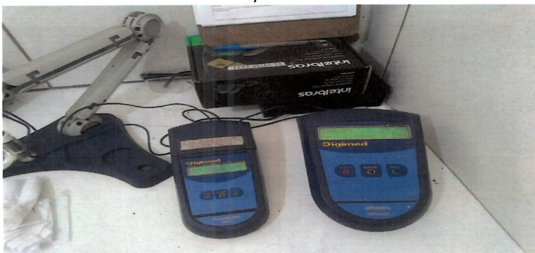
Foto 14 – Turbidímetro e phmetro da Unidade de Tratamento.
